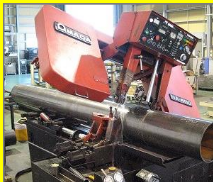
การตัดShell(ผิว) (เครื่องตัดอัตโนมัติ Amada)
